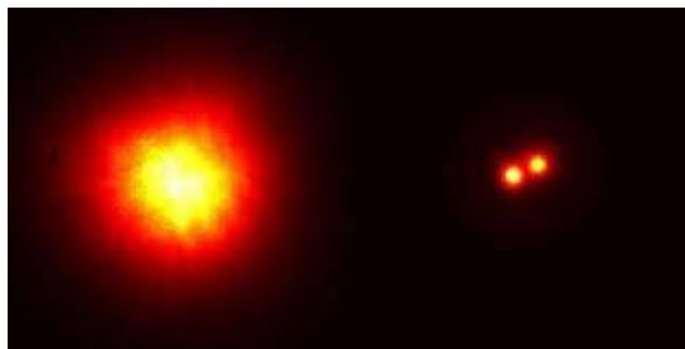
Fig. 3. 9. Observation d'un système stellaire binaire : image directe et image corrigée par l'optique adaptative et l'interférométrie optique.
