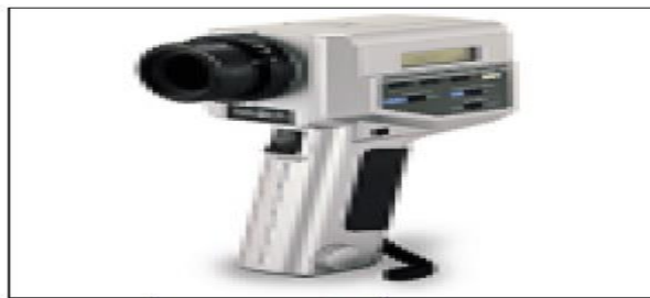
Fig I. 10: L'appareil de mesure: luminance-mètre. Source: M. Bodart (2002)
