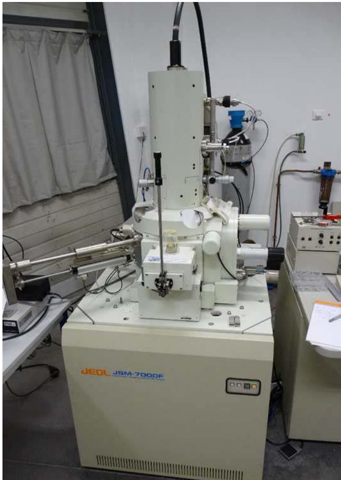
Figure III -8 : Dispositif expérimental de MEB - Microscope JEOL JSM 7000F LMPM Institut P' de l'E.N.S.M.A de Poitiers
