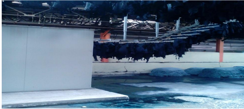
Figure I.9. Photographie de l'étape de séchage de l'unité de la tannerie ACED/Batna
