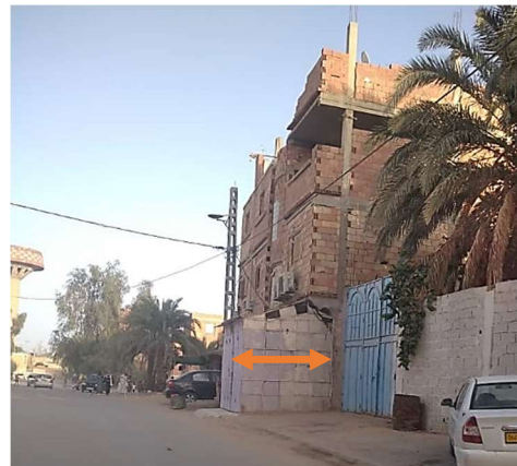
Photo 6: Expansion horizontale au détriment du trottoir.
