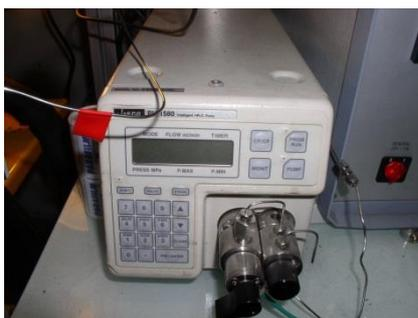
**Figure 3.3** : la pompe haute pression (PU-1587 de la société JASCO)
