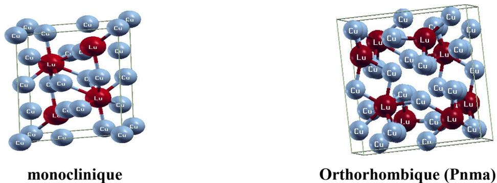
**Figures IV. 7 :** Représentation schématique des deux structures proposées pour le composé  $\text{Cu}_9\text{Lu}_2$ .
