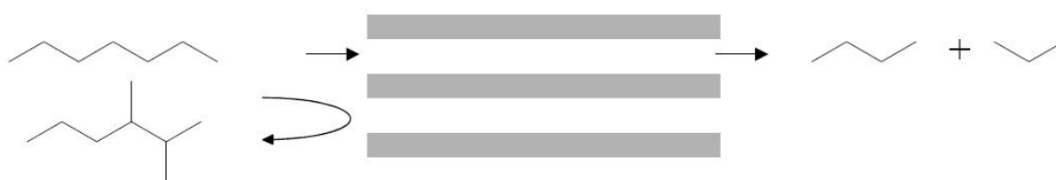
a) Sélectivité vis-à-vis des réactifs : craquage du n-heptane -
