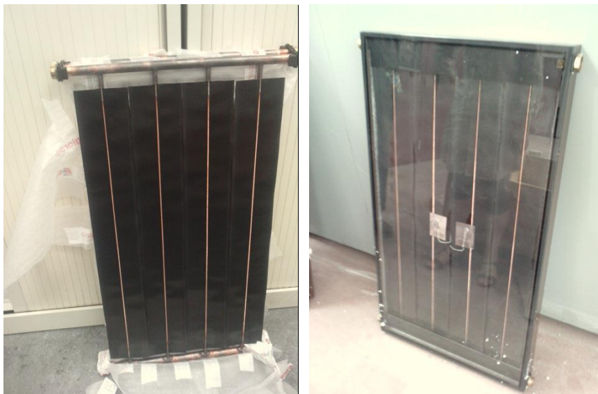
Figure 4.1 : Photographies du capteur sans (gauche) et avec (droite) vitrage
