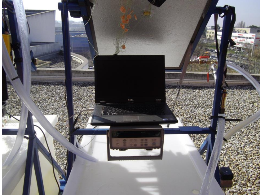
Figure 4.5 : Photographie du capteur équipé avec la centrale de mesure
