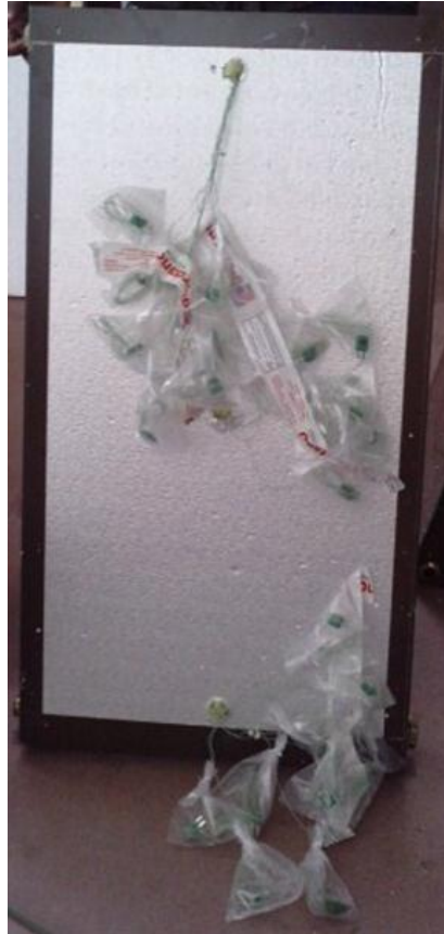
Figure 4.4 : Photographies du capteur lors de l'emplacement des thermocouples dans les tubes (a) et vue des thermocouples sortis à travers l'isolant (b).
