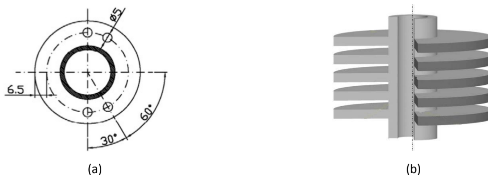
Figure 1.5 : Ailettes annulaires circulaires: (a) avec des perforations [37] (b) planes [36].
