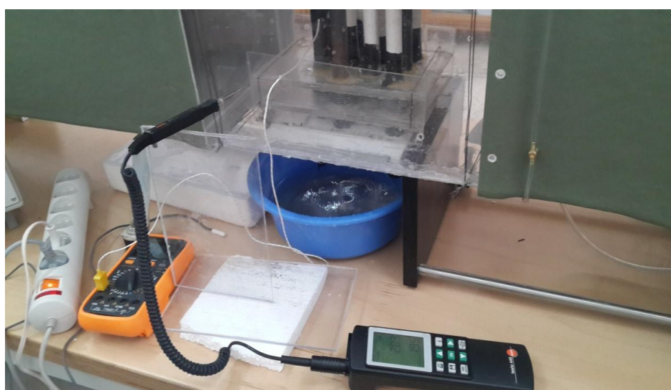
Figure 2.6 : Mesure de la température et de la vitesse d'écoulement par l'appareil Testo 445.
