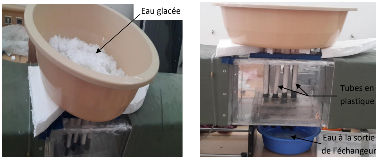
Figure 2.5 : Veine d'essai avec la circulation verticale de l'eau froide.
