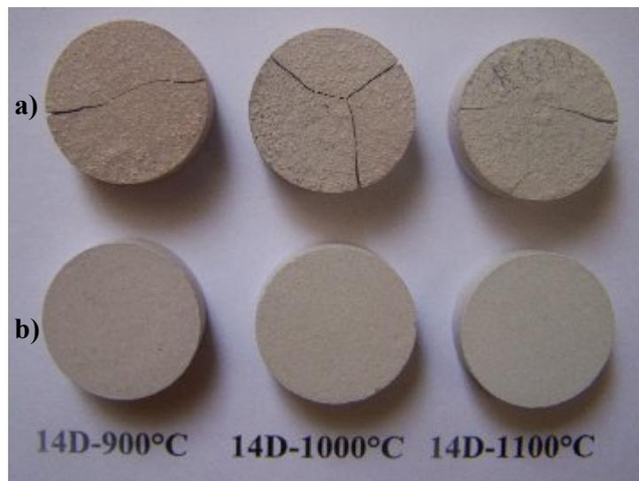
**Figure IV-9 :** Mise en évidence des fissures due à la déshydroxylation d'échantillons frittés pendant 1h à différentes températures. a) échantillons non calcinés, b) échantillons préalablement calcinés à 600°C.
