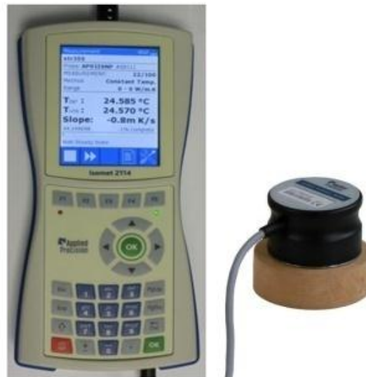
Figure II.11. Appareil ISOMET 2114 (unité de commande et sonde).
