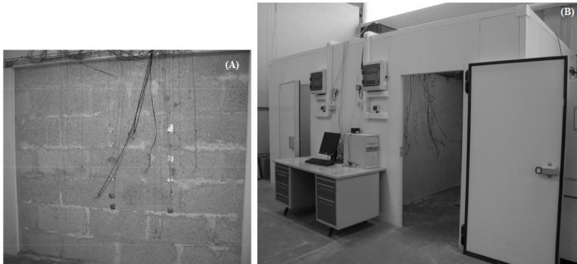
Figure IV.2. Paroi pour le test (A), et une chambre bi-climatique (B) [4].
