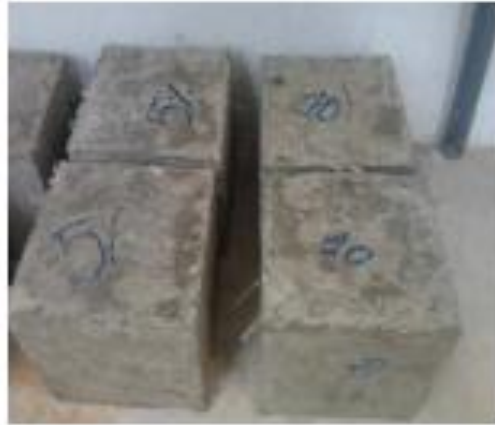
Figure I.16. Echantillons de composite fibres-matrice à base de ciment [18].
