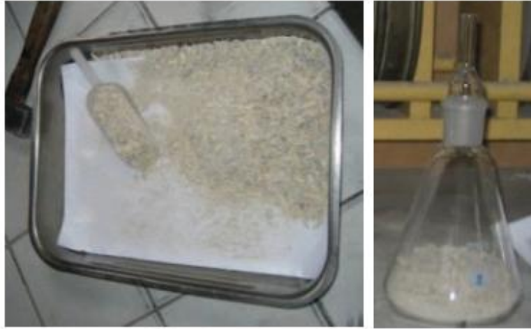
Figure II.4. Méthode pycnométrique (broyage et mise en place) [13].
