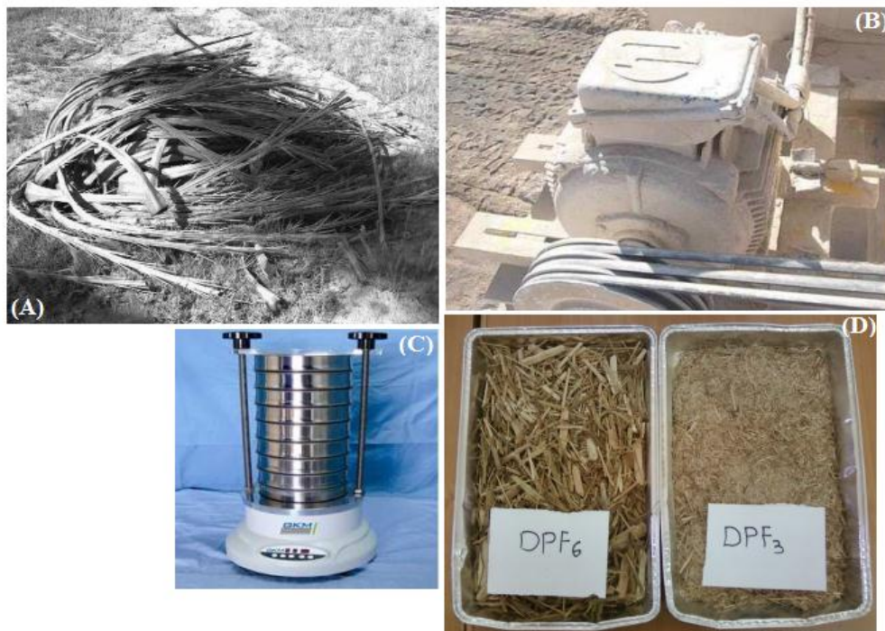
Figure I.12. Préparation des fibres de bois de palmier dattier : (A) bois de palmier dattier, (B) broyeur mécanique (moteur de base), (C) appareil de tamisage du bois de palmier dattier, et finalement (D) les fibres de bois de palmier dattier avec différentes tailles.
