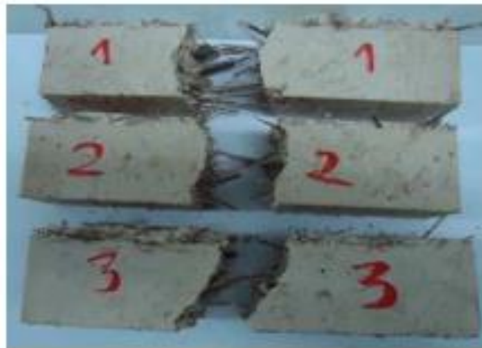
Figure I.14. Echantillons de composite gypse-fibres après des essais de flexion [17].
