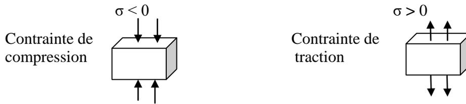
**Figure II.3** : Contraintes de traction et de compression appliquées à un corps solide.
