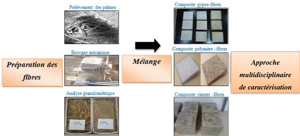
Figure I.11. Etapes de préparation de différents composites à base des fibres de palmier dattier.
