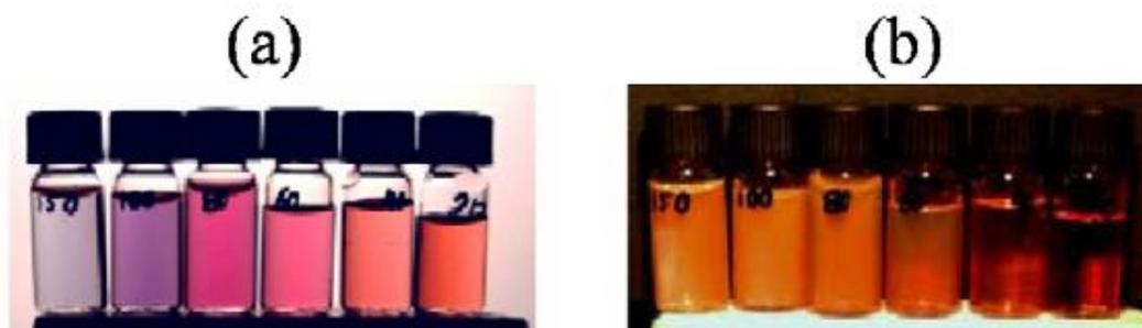
Figure I.7. Photographie en lumière blanche, en transmission (a) et en réflexion (b), de solutions colloïdales contenant des nanoparticules sphériques de différentes tailles. [19].
