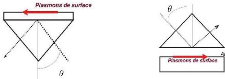
Figure 1.4. Représentation des deux méthodes dites ATR: à gauche, configuration de Kretschmann-Raether, à droite, configuration d'Otto [9].
