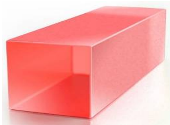
Figure 1.10 : Cristal optique de saphir dopé au titane pour application laser.
