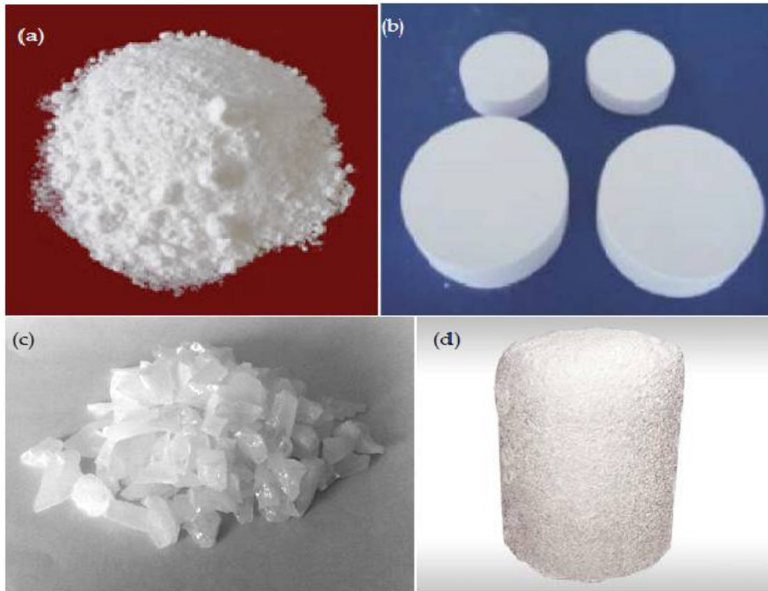
Figure I.6 : Matières premières d' Al_2O_3 : (a) poudre, (b) charge frittée, (c) cristal fissuré, (d) lingot polycristallin [7].
