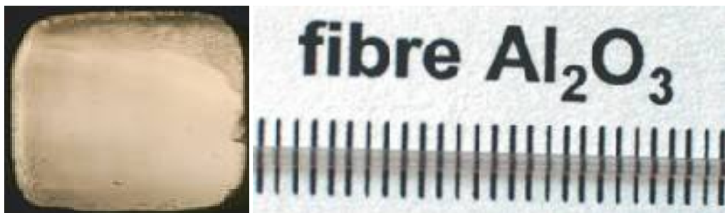
Figure II.14 : Saphir cristallin fibré de format carré en bon accord avec le format du creuset utilisé [7].
