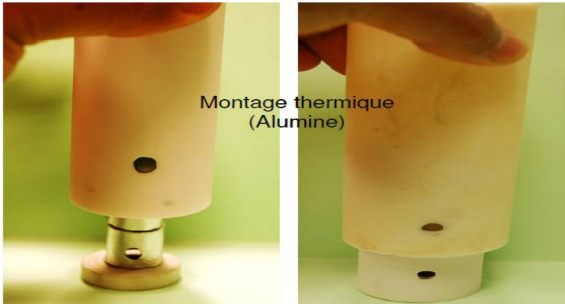
Figure II.5 : Construction céramique autour du creuset [7].
