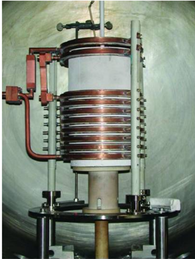
Figure II.19 : Système de croissance de Czochralski (Laboratoire de Czochralski-diélectriques à IKZ) [90].
