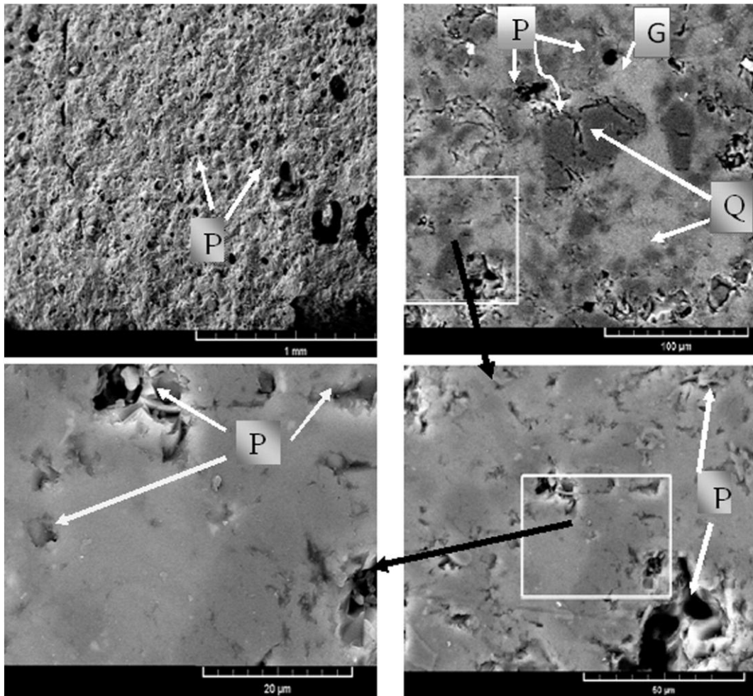
الشكل IV-6 صور بالمجهر الالكتروني الماسح لسطح عينة بورسولان سني بدون اضافة ملبدة عند 1200^{\circ}\text{C} (Q: كوارتز، G: الطور الزجاجي، P: الفراغات).
