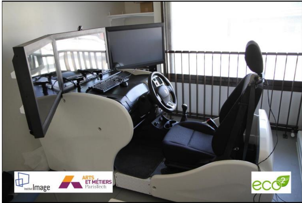
شكل رقم (7) جهاز المحاكاة Eco 2 لنانت (Plouzeau, 2016, p. 7)
