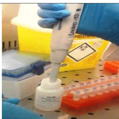
Photo N° 20 : Lavage de l'ADN extrait par Buffer W1.
