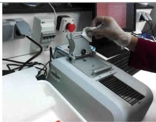
Photo N° 35 : Nettoyage des deux surfaces optiques avec un papier absorbant.
