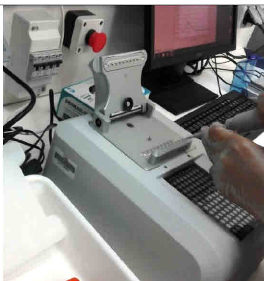
Photo N° 36 : Dépôt de 1 \mu l de l'échantillon de l'ADN dans la cellule de l'appareil.
