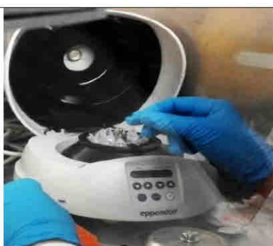
Photo N° 22 : Séchage de la membrane de silice par centrifugation.
