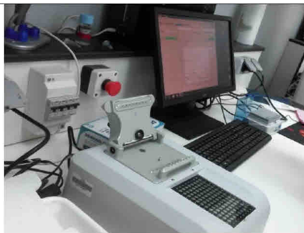
Photo N° 32 : NanoDrop relié à un microordinateur
