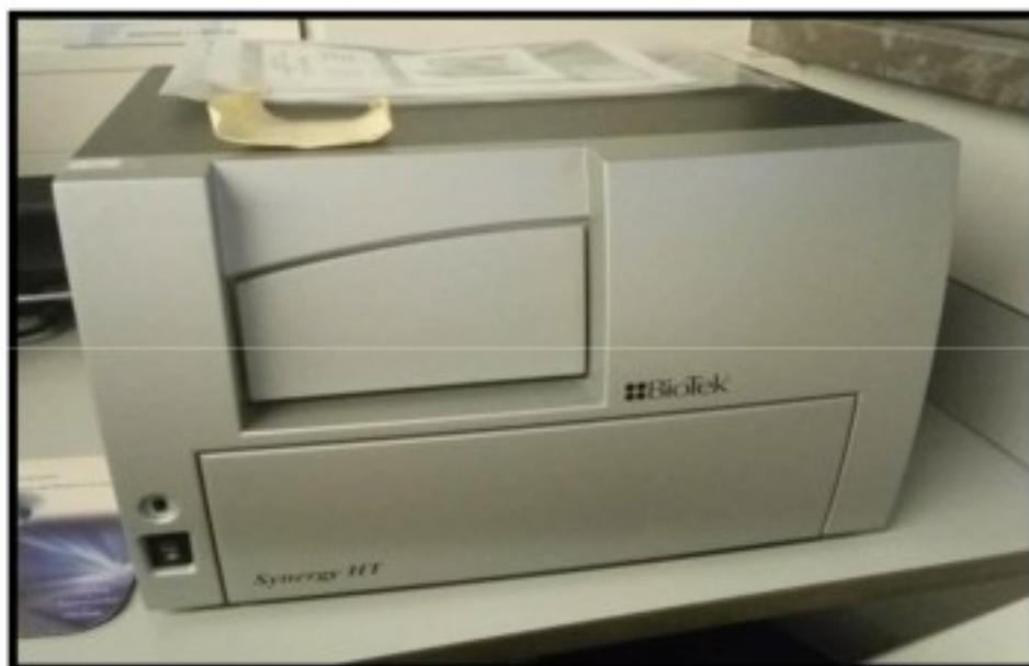
**Figure 13.** Spectrophotomètre Biotek Synergy HT, lecteur multi détection spécial microplaque (Vermont, USA).
