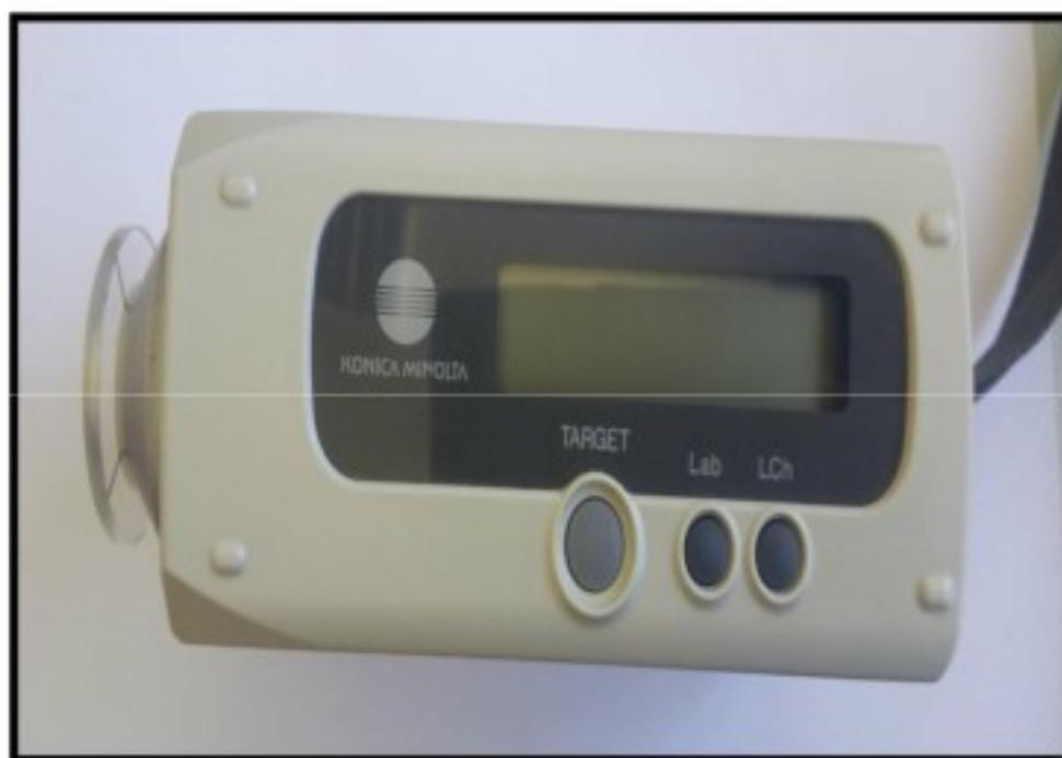
Figure 17. Colorimètre (Konica Minolta Sensing, INC. CR-10, Japon).
