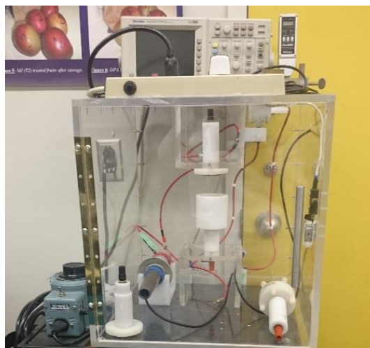
Figure 29: Installation du champ électrique pulsé.
