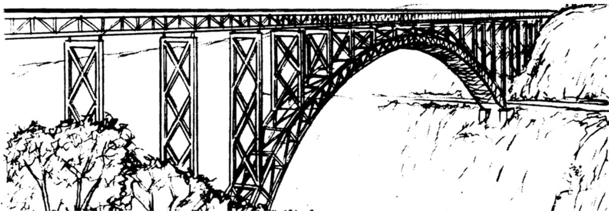
Fig.104 Pont en arc, construit en acier
