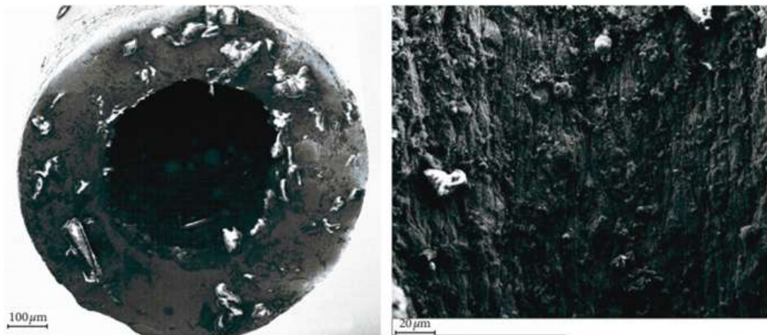
Figure 1.9. Image de microscopie électronique à balayage (SEM, Scanning electron microscopy) d'une coupe transversale du microcanal rugueux, Zhang et al. (2019) .
