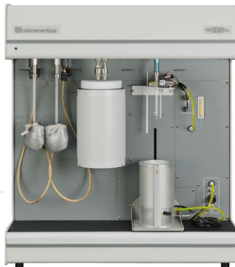
Figure II.10 Appareil de volumétrie d'adsorption d'azote
