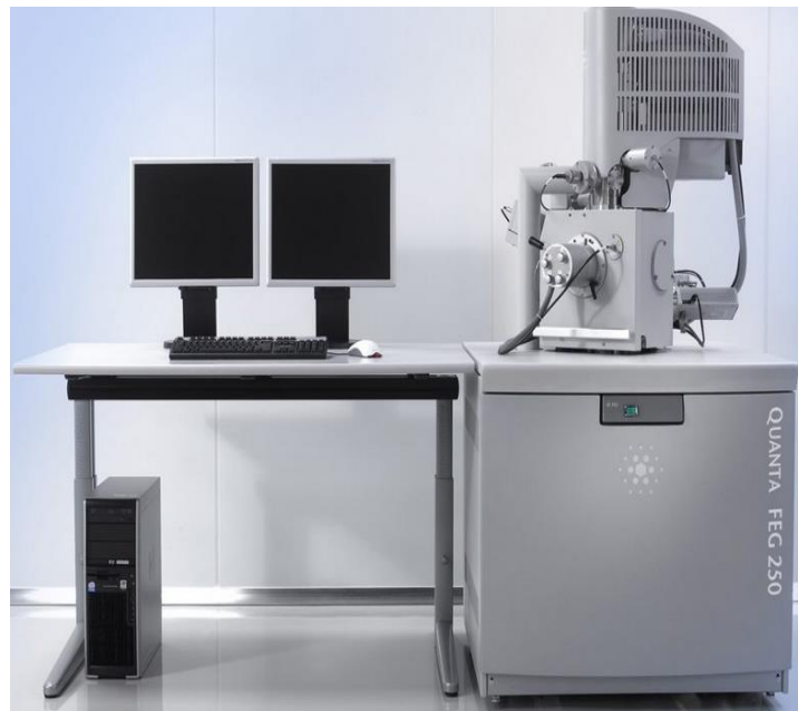
Figure II.8 Microscope électronique à balayage (MEB)
