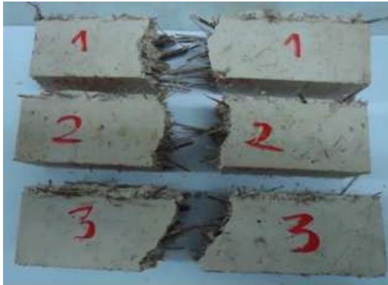
Figure I-14. Echantillons du composite gypse/fibre de palmier dattier après l'essai de flexion [25]
