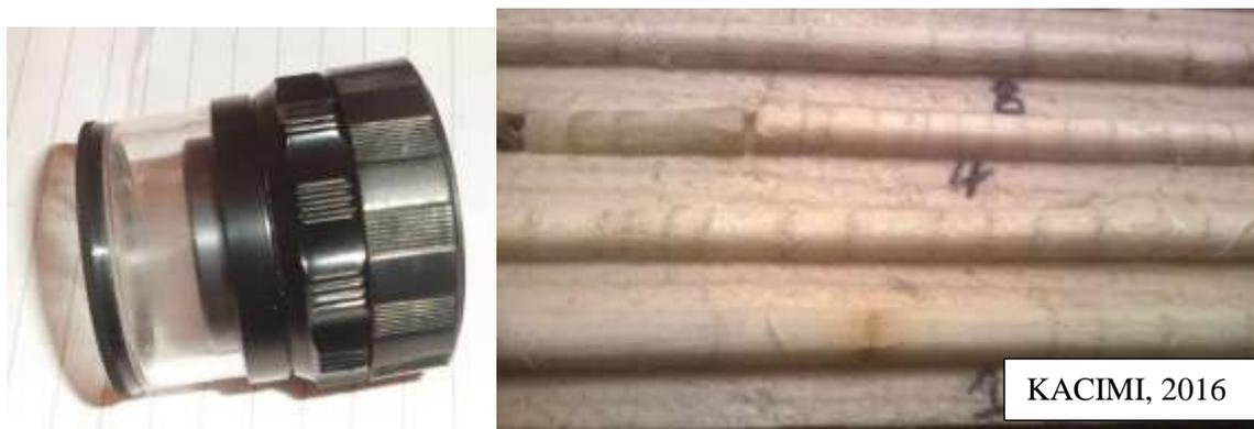
**Figure 3.3-** Micromètre oculaire (x10) **Figure 3.4** Planchettes de bois renfermant les carottes.
