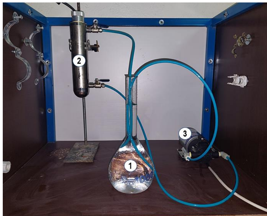
Figure IV.25 : Montage de photocatalyse « système continu ».
