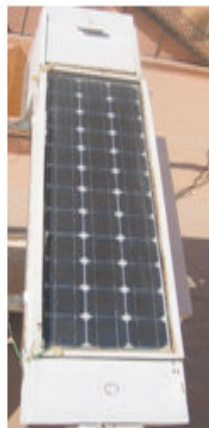
Figure 2.16 Prototype de modèle PV/T à air réalisée à l'URAER
