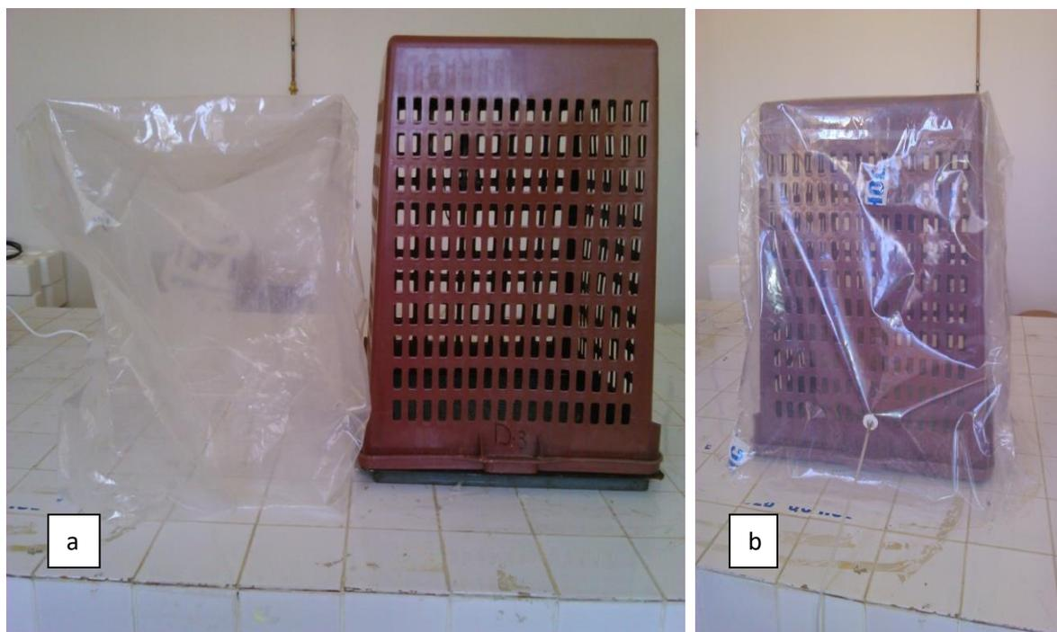
**Photo 10 (a et b).** La cage utilisée dans le piégeage de l'ammoniac surmontée du cache en plastique.
