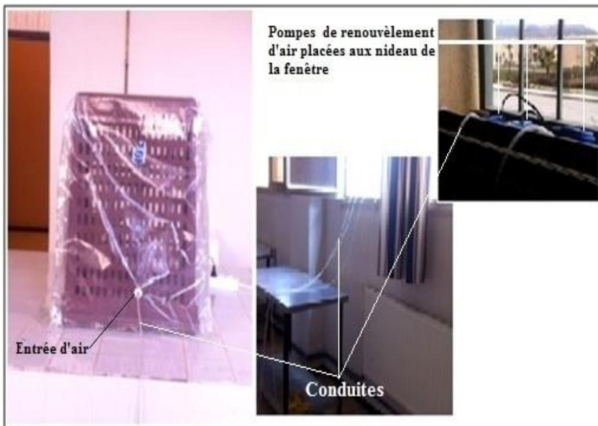
**Photo 13.** L'emplacement des pompes de renouvellement de l'air des cages.
