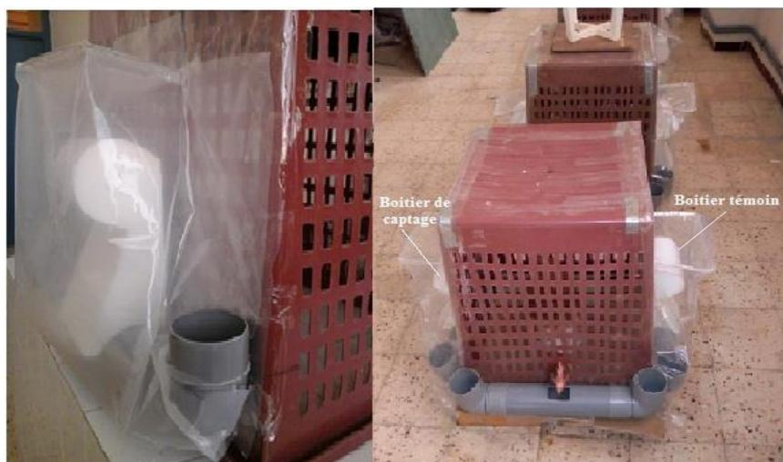
**Photo 08.** L'emplacement des boîtiers et du cache en plastique lors de la deuxième période de l'expérimentation.
