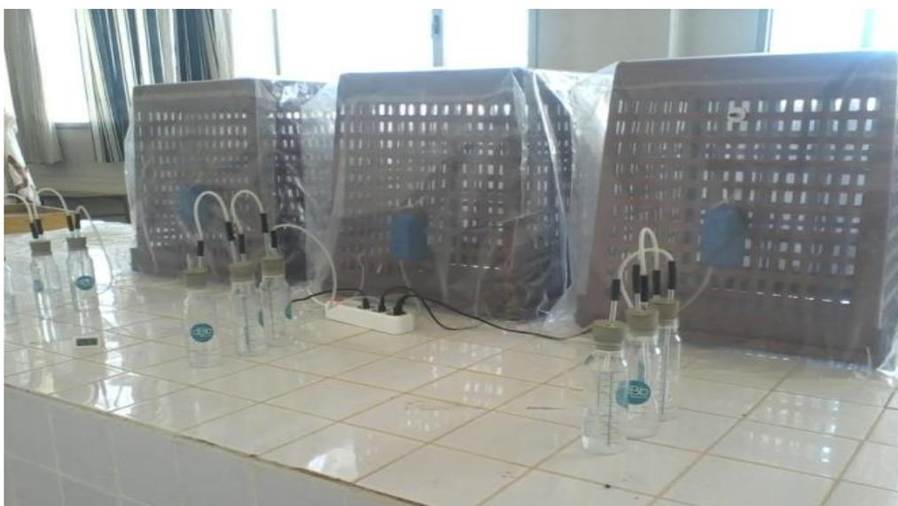
**Photo 12.** Le dispositif expérimental d'estimation de l'ammoniac.
