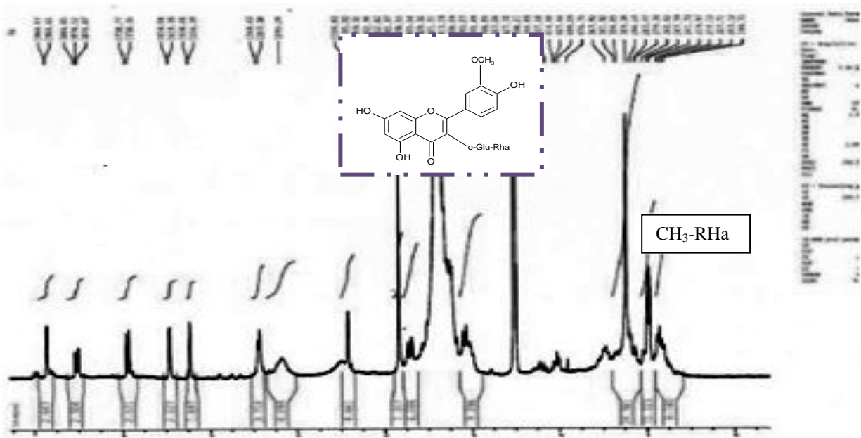
الشكل 2: طيف الرنين النووي المغناطيسي للبروتون للمركب CA3 (DMSO-d6)
