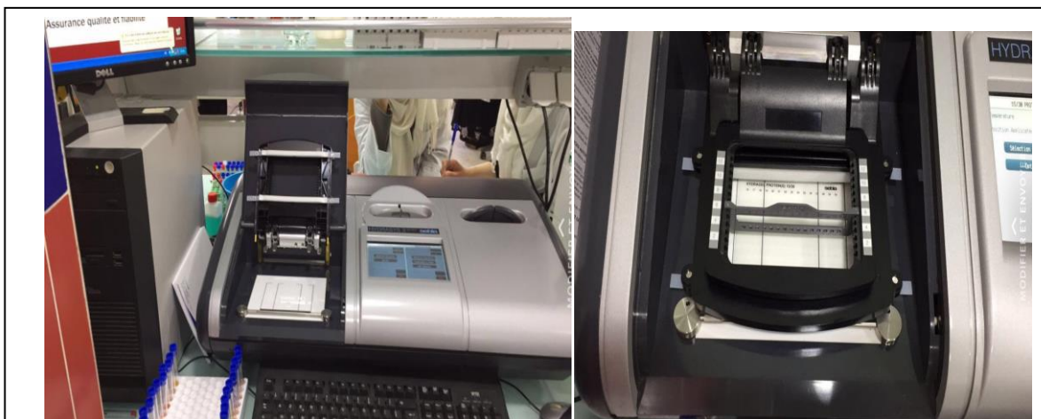
Photo 9 : Ouverture du capot du module de migration avec la remontée des chariots porte-applicateurs et porte-électrodes (photo personnelle)
