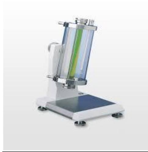
**Viscosimètre à chute de bille pour l'huile**
